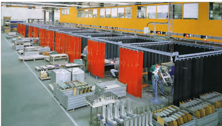
TransTac-System-Bauteile für Schutzvorhänge und Lamellen ermöglichen schnell und mühelos jede Art der Arbeitsplatzsicherung. Die Teile sind im Nu mit einfachen Klemmverbindungen montiert.
