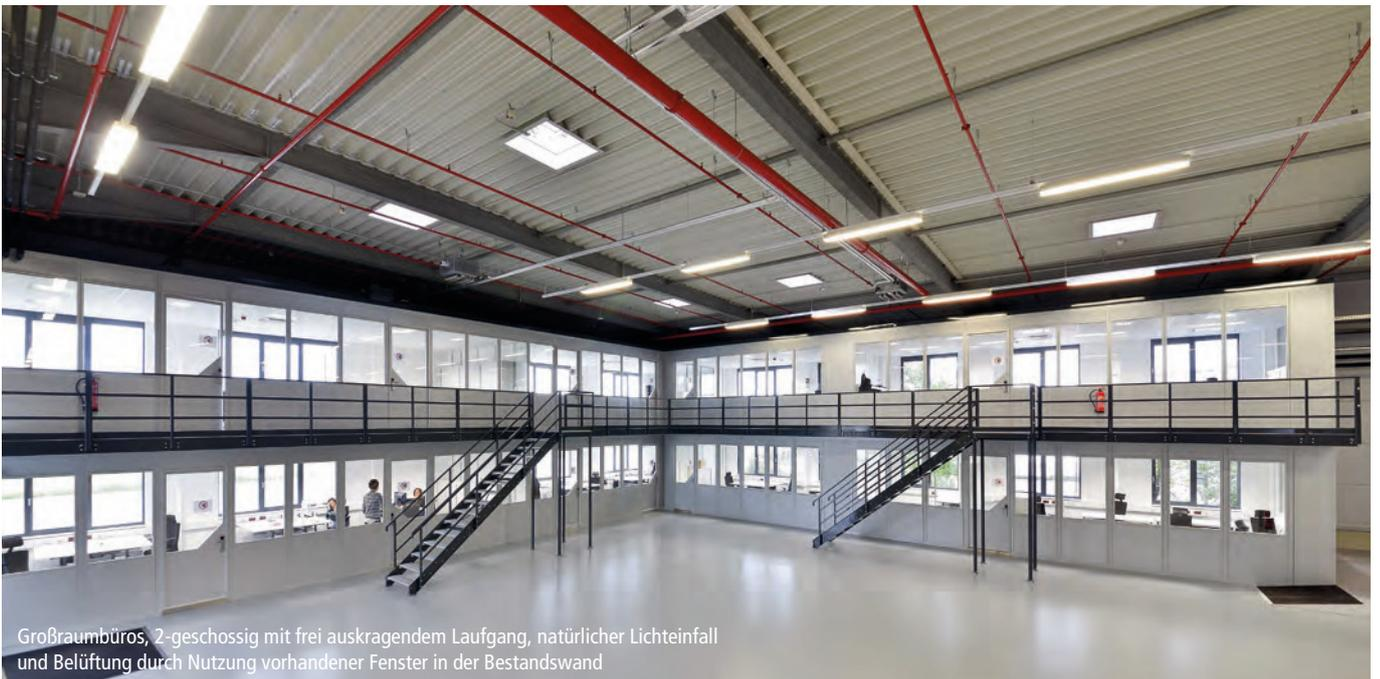
Großraumbüros, 2-geschossig mit frei auskragendem Laufgang, natürlicher Lichteinfall und Belüftung durch Nutzung vorhandener Fenster in der Bestandswand
