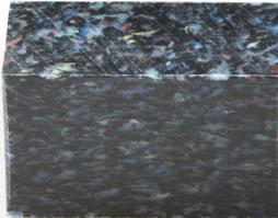
Das blaugelb Füllstück besteht aus einem extrem vielseitigen ultrahochmolekularen Niederdruck-Polyethylen mit einem Molekulargewicht von ca. 500.000 g/mol. und einer Beimischung von qualitativ gleichbleibenden Regeneraten. Eine große Verschleißfestigkeit, eine hohe Schlagzähigkeit und hervorragende Gleiteigenschaften prädestinieren es z.B. für den Einsatz im Schwellenbereich, Türen-Bau oder Maschinenbau.
