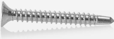
Die blaugelb Armierungsschraube mit Bohrspitze dient der kraftschlüssigen Verschraubung von Armierungsstahl mit Kunststoff-Fensterprofilen. Hergestellt aus einem einsatzgehärteten Kohlenstoffstahl, erfährt die Armierungsschraube eine galvanische Verzinkung, um einen bestmöglichen Korrosionsschutz zu gewährleisten.
