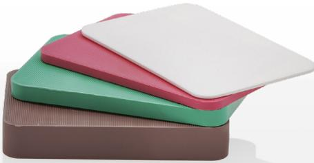
Der blaugelb Montageklotz, hergestellt aus hochwertigem Polypropylen, ist wegen seines massiven Aufbaus im Vollgussverfahren ideal zur fachgerechten Lastabtragung bei der Fenster- und Türenmontage geeignet. Seine Randverbundverträglichkeit macht ihn ebenso wie die hohe Drucklast zu einem wichtigen und unverzichtbaren Helfer. Die Feinriffelung an der Oberfläche der blaugelb Montageklötze sorgt für eine hohe Rutschfestigkeit und somit auch für mehr Sicherheit beim Ausgleichen.
