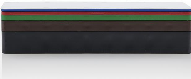
Die blaugelb Unterlegplatten HST (Hebeschiebetüren) hergestellt aus Polystyrol PS sind dank Ihrer Produktgröße bzw. Fläche ideal zur fachgerechten Lastabtragung von Elementen mit einer sehr großen Bautiefe (z. B. HebeSchiebetürelemente). Die Feinriffelung an der Oberfläche der blaugelb Unterlegplatten HST sorgt für eine hohe Rutschfestigkeit und somit auch für mehr Sicherheit beim Ausgleichen.
