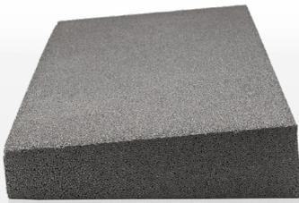
Das blaugelb Thermofensterbankprofil dient zur Ausbildung einer 5° Neigung im Brüstungsbereich. Durch das blaugelb Thermofensterbankprofil wird beim Anbringen der Außenfensterbank die richtige Schräglage (ca. 5° Neigung) eingehalten. Durch die punktuelle blaugelb Hybrid Polymer Power Fix Fixierung mit der druckfesten und stabilen Basis unter der Außenfensterbank wird das Abheben der Fensterbank verhindert.
