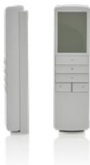
Der blaugelb Funk-Handsender 15 ist die elegante Schaltzentrale für mehrere Rollladenmotoren. Hierbei wird der kabellose Sender an den jeweiligen Rollladenmotor angelernt und lediglich bei Bedarf der Rahmen des Senders an einer Wand befestigt ohne dabei aufwendige Kabel zum Rollladenmotor verlegen zu müssen.
