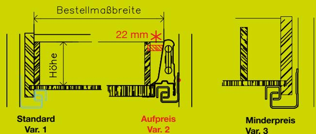
Wenn der Einsatz in eine bestehende Lade oder Box kommt, müssen Sie die Zargenstärke etc. der bestehenden Lade/Box abziehen, damit der Einsatz in die Lade passt.
