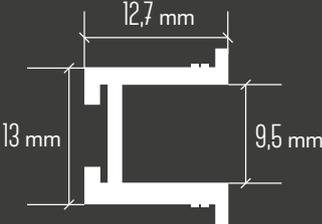
Korpusführungsschiene aus Kunststoff muss in das Aluminiumprofil eingeklipst werden (separat bestellen).
