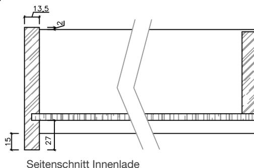
Wir verwenden bei unseren Schubladen eine 10 mm Zinkenteilung! Zinkenabschluss oben und unten bei Sonderhöhen variabel! Laden vom Typ B, IL und EZ werden immer mit Bohrung für Schubladenföhrung im Hinterstück geliefert!
