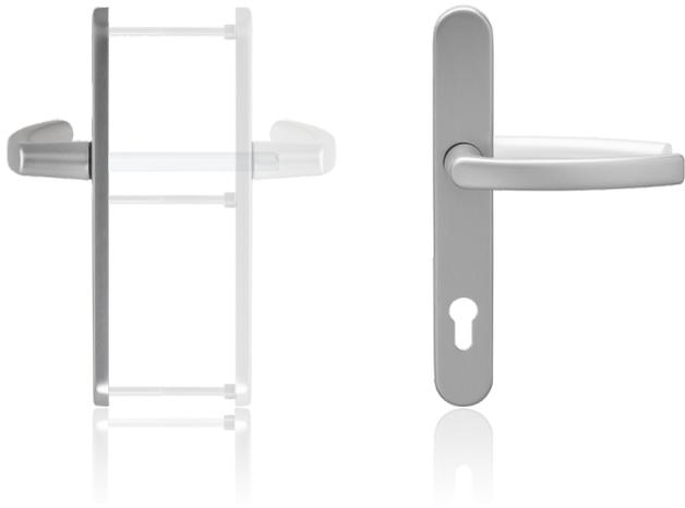
Die blaugelb Drückergarnitur ½ DGT35 innen PZ92 mit einer Schildbreite von 35 mm (Entfernung PZ92) ist für Holz-, Kunststoff- und Metallaußentüren geeignet. Sie ist mit einer Hochhaltefeder zur exakten Positionierung des Drückers ausgestattet. Dabei unterstützt die Hochhaltefeder die Schlossnussfeder zusätzlich bei der Rückholung der Drückerfalle.
