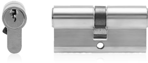
Die blaugelb Profil Doppelzylinder PDZ 1758 sind aus Messing vernickelt und weisen ein 5-stiftiges Normalprofil mit einem paracentrischen Schlüsselprofil für Einzelschließungen auf. Solange in einer Zylinderseite ein Schlüssel steckt, ist die gegenüberliegende Zylinderseite gesperrt. Die Zylinder sind gegen mechanische Angriffe geschützt – sie warten durch einen serienmäßigen Anbohr- und Schlagpicking-Schutz mit einer erhöhten Einbruchsicherheit auf.
