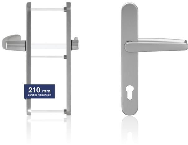
Die blaugelb Rollladengarnitur NGT35/92/210 mit einer Schildbreite von 35 mm (Entfernung PZ92) ist für Außentüren aus Holz, Kunststoff und Metall geeignet. Der niedrige (flache) Drücker ist speziell für Außentüren mit Rollläden, Sonnenschutz, Jalousien und Insektenschutz konzipiert. Die blaugelb Rollladengarnitur NGT35/92/210 ist mit einer Rückholmechanik zur exakten Positionierung des Drückers ausgestattet.
