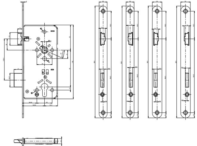
Das blaugelb Haustürschloss 24 PZW, abgerundeter Stulp ist mit einer Profilzylinderlochung Entfernung 92 mm ausgestattet. Der Schlosskasten ist komplett geschlossen und voll verzinkt. Das Haustürschloss kann an einflügeligen Falz- und Stumpftüren eingesetzt werden. Die Falle und der Riegel des blaugelb Haustürschlosses 24 PZW, abgerundeter Stulp sind aus robustem Zinkdruckguss. Das Schloss ist mit herkömmlichen E-Öffnern kombinierbar.
