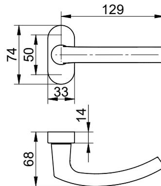
Die blaugelb Drückergarnitur ovale Rosette mit einer Breite von 33 mm ist für Holz-, Kunststoff- und Metallaußentüren geeignet. Sie ist mit einer Hochhaltefederung zur exakten Positionierung des Drückers ausgestattet. Dabei unterstützt die Hochhaltefeder die Schlossnussfeder zusätzlich bei der Rückholung der Drückerfalle.
