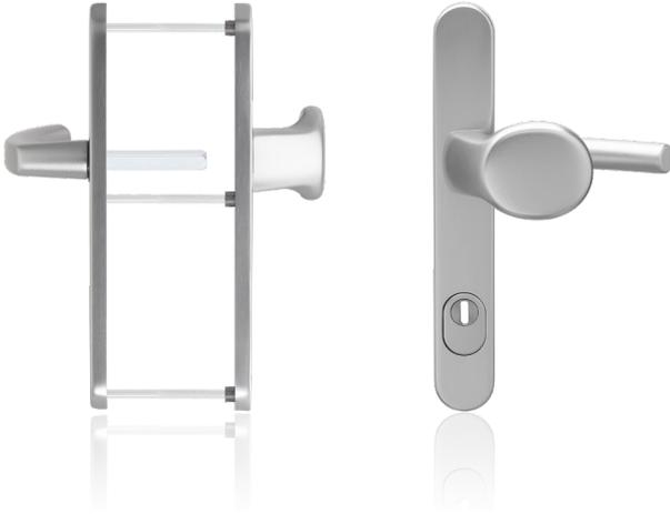
Die blaugelb Wechselgarnitur KGT35 PZ92 ZA mit einer Schildbreite von 35 mm (Entfernung PZ92) und einem Kernziehschutz ist für Holz-, Kunststoff- und Metallaußentüren geeignet. Sie ist mit einer Hochhaltefeder zur exakten Positionierung des Drückers ausgestattet. Dabei unterstützt die Hochhaltefeder die Schlossnussfeder zusätzlich bei der Rückholung der Drückerralle.
