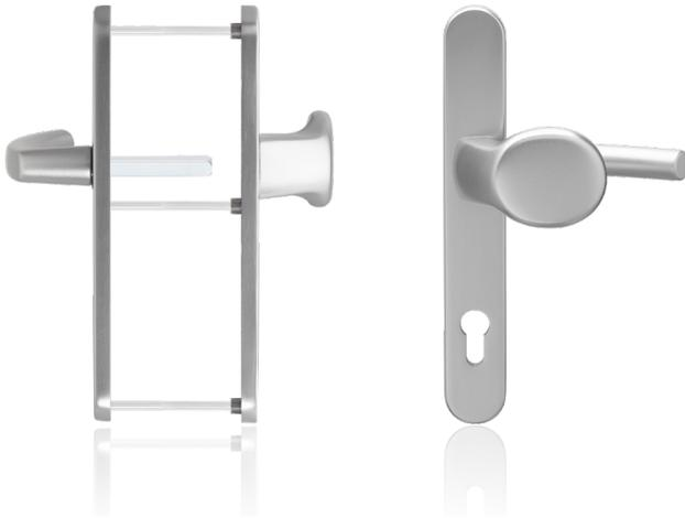
Die blaugelb Wechselgarnitur KGT30 PZ92 mit einer Schildbreite von 30 mm (Entfernung PZ92) ist geeignet für Holz-, Kunststoff- und Metallaußentüren. Sie ist mit einer Hochhaltefederung zur exakten Positionierung des Drückers ausgestattet. Dabei unterstützt die Hochhaltefeder die Schlossnussfeder zusätzlich bei der Rückholung der Drückerfalle.
