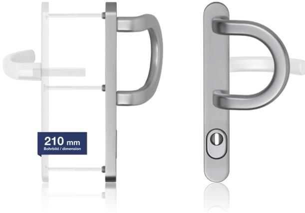
Die blaugelb Wechselgarnitur ½ BGT35/92/210 außen ZA mit einer Schildbreite von 35 mm (Entfernung PZ92) und einem Kernziehschutz ist für Holz-, Kunststoff- und Metallaußentüren geeignet. Die Garnitur kann mit einer blaugelb ½ DGT35/92/210 innen kombiniert werden.
