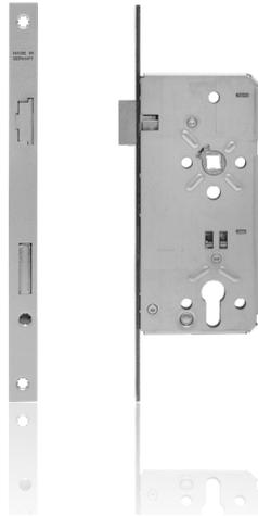
Das blaugelbe Haustürschloss 24 PZW, eckiger Stulp ist mit einer Profilzylinderlochung Entfernung 92 mm ausgestattet. Der Schlosskasten ist komplett geschlossen und voll verzinkt. Das Haustürschloss kann an einflügeligen Falz- und Stumpftüren eingesetzt werden. Die Falle und der Riegel des blaugelben Haustürschlosses 24 PZW, eckiger Stulp sind aus robustem Zinkdruckguss. Das Schloss ist mit herkömmlichen E-Öffnern kombinierbar.
