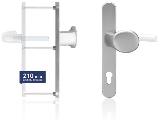
Die blaugelb Wechselgarnitur ½ KGT35/92/210 außen mit einer Schildbreite von 35 mm (Entfernung PZ92) ist für Holz-, Kunststoff- und Metallaußentüren geeignet. Die Garnitur kann mit einer blaugelb ½ DGT35/92/210 innen kombiniert werden.
