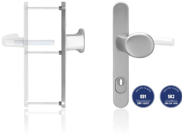
Die blaugelb Wechselgarnitur ½ KGT35 außen PZ92 ZA ES1 mit einer Schildbreite von 35 mm (Entfernung PZ92) und einem ES1 geprüften Kernziehschutz ist für Holz-, Kunststoff- und Metallaußentüren geeignet. Damit die Wechselgarnitur etwaigen Anbohrversuchen standhalten kann, wurde die Unterkonstruktion aus gehärtetem Stahl gefertigt. Die Wechselgarnitur kann mit einer blaugelb ½ DGT35 innen PZ92 kombiniert werden.
