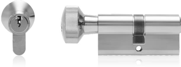
Die blaugelb Profilknäufzylinder PDZ 1758 sind aus Messing vernickelt und weisen ein 5-stiftiges Normalprofil mit einem parazentrischen Schlüsselprofil für Einzelschließungen auf. Der Schlüssel kann in allen Stellungen des Drehknäufs eingeführt werden, der Schließbart bleibt dabei stets mit dem Knäuf verbunden. Die Zylinder sind gegen mechanische Angriffe geschützt – sie warten durch einen serienmäßigen Anbohr- und Schlagpickingschutz mit einer erhöhten Einbruchssicherheit auf.
