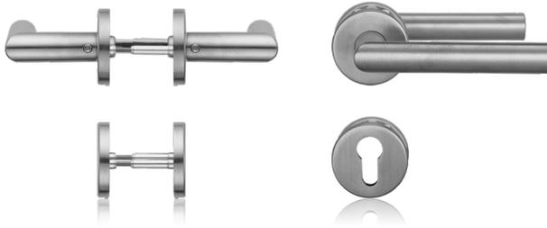
Die blaugelb Drückergarnitur ZT/DGT FS 90°-Form PZ Klasse 4 ist für Feuer-, Rauch- und Fluchtwegtüren mit erhöhtem Sicherheitsanspruch in puncto Feuerschutz nach DIN 18273 und für den Objektbereich nach DIN EN 1906 geeignet und dementsprechend geprüft. Die mitgelieferten Schlüsselrosetten (PZ) verfügen ebenso wie die Drückerrosetten über Stütznocken zur exakten und dauerhaften Positionierung an der Tür.
