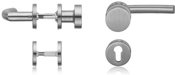
Die blaugelb Wechselgarnitur ZT/KGT FS 1758 PZ Klasse 4 ist für Feuer-, Rauch- und Fluchtwegtüren mit erhöhtem Sicherheitsanspruch in puncto Feuerschutz nach DIN 18273, für Notausgangverschlüsse nach DIN EN 179 und für den Objektbereich nach DIN EN 1906 geeignet und dementsprechend geprüft. Die mitgelieferten Schlüsselrosetten (PZ) verfügen ebenso wie die Drückerrosetten über Stütznocken zur exakten und dauerhaften Positionierung an der Tür.
