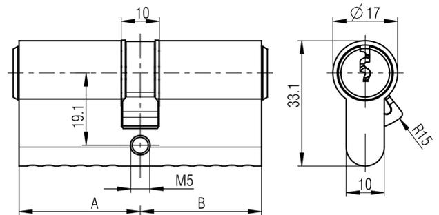
Die blaugelb Profildoppelzylinder PDZ 1758 beidseitige Gefahrenfunktion sind aus Messing vernickelt und weisen ein 5-stiftiges Normalprofil mit einem parazentrischen Schlüsselprofil für Einzelschließungen auf. Der Zylinder lässt sich öffnen, wenn auf der Gegenseite ein Schlüssel steckt. Die Zylinder sind gegen mechanische Angriffe geschützt – sie warten durch einen serienmäßigen Anbohr- und Schlagpicking-Schutz mit einer erhöhten Einbruchsicherheit auf.
