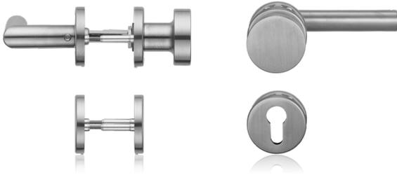
Die blaugelb Wechselgarnitur ZT/KGT FS 90°-Form PZ Klasse 4 ist für Feuer-, Rauch- und Fluchtwegtüren mit erhöhtem Sicherheitsanspruch in puncto Feuerschutz nach DIN 18273, für Notausgangverschlüsse nach DIN EN 179 und für den Objektbereich nach DIN EN 1906 geeignet und dementsprechend geprüft. Die mitgelieferten Schlüsselrosetten (PZ) verfügen ebenso wie die Drückerrosetten über Stütznocken zur exakten und dauerhaften Positionierung an der Tür.
