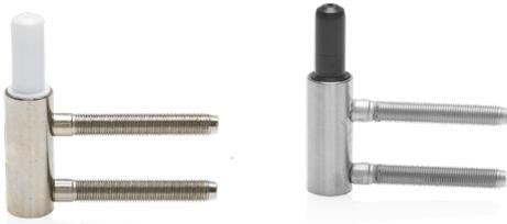
Das blaugelb Rahmenteil RT34 WF, 2-teilige Bandrolle, ist vernickelt oder aus Edelstahl und weist dadurch eine höhere Lebensdauer auf und ist gegen die Abnutzungen im Alltag besser geschützt. Die konisch zulaufenden Zapfen erleichtern ein Eindrehen des Zapfens. Kombinierbar ist das blaugelb Rahmenteil RT34 WF mit folgenden blaugelb Flügelteilen:
