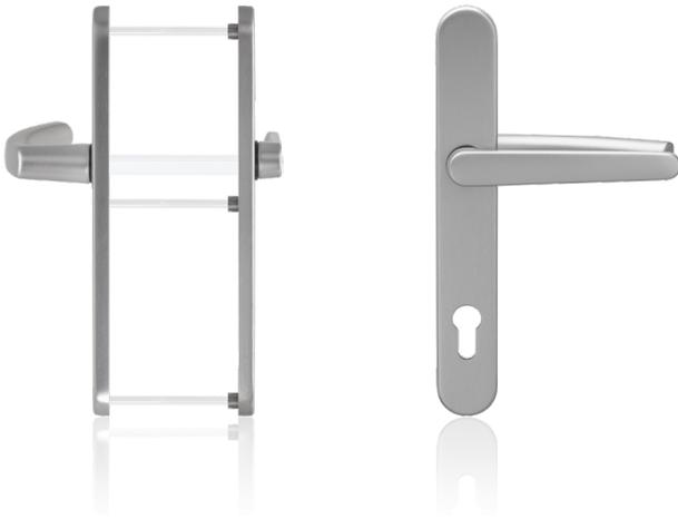
Die blaugelb Rolladengarnitur NGT35 PZ92 mit einer Schildbreite von 35 mm (Entfernung PZ92) ist für Holz-, Kunststoff- und Metallaußentüren geeignet. Der niedrige (flache) Drücker ist speziell für Außentüren mit Rollläden, Sonnenschutz, Jalousien und Insektenschutz konzipiert. Sie ist mit einer Hochhaltefeder zur exakten Positionierung des Drückers ausgestattet. Dabei unterstützt die Hochhaltefeder die Schlossnussfeder zusätzlich bei der Rückholung der Drückerfalle.
