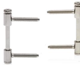
Das blaugelb Flügelteil FT26 WF, 3-teilige Bandrolle, ist vernickelt oder aus Edelstahl und weist dadurch eine höhere Lebensdauer auf und ist gegen die Abnutzungen im Alltag besser geschützt. Das blaugelb Flügelteil FT26 WF ist mit einer wartungsfreien Gleitlagertechnik und einem Bandstift mit Verdrehsicherung ausgestattet. Kombinierbar ist das blaugelb Flügelteil FT26 WF mit folgenden blaugelb Rahmenteilen:
