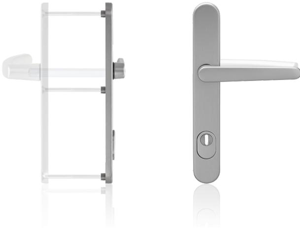
Die blaugelb Rollladengarnitur ½ NGT35 außen PZ92 ZA mit einer Schildbreite von 35 mm (Entfernung PZ92) und einem Kernziehschutz ist für Holz-, Kunststoff- und Metallaußentüren geeignet. Der niedrige (flache) Drücker ist speziell für Außentüren mit Rollläden, Sonnenschutz, Jalousien und Insektenschutz konzipiert. Die blaugelb Rollladengarnitur ½ NGT35 außen PZ92 ZA kann mit einer blaugelb ½ DGT35 innen PZ92 kombiniert werden.
