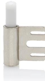
Das blaugelb Rahmenteil RT81 WF, 2-teilige Bandrolle, ist vernickelt und weist dadurch eine höhere Lebensdauer auf und ist gegen die Abnutzungen im Alltag besser geschützt. Das blaugelb Rahmenteil RT81 WF ist mit einer wartungsfreien Gleitlagertechnik und einer stiftlaufenden Ausführung für weniger Reibung ausgestattet. Kombinierbar ist das blaugelb Rahmenteil RT81 WF mit folgenden blaugelb Flügelteilen:
