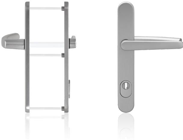
Die blaugelb Rollladengarnitur NGT35 PZ92 ZA mit einer Schildbreite von 35 mm (Entfernung PZ92) und einem Kernziehschutz ist für Holz-, Kunststoff- und Metallaußentüren geeignet. Der niedrige (flache) Drücker ist speziell für Außentüren mit Rollläden, Sonnenschutz, Jalousien und Insektenschutz konzipiert. Sie ist mit einer Hochhaltefeder zur exakten Positionierung des Drückers ausgestattet. Dabei unterstützt die Hochhaltefeder die Schlossnussfeder zusätzlich bei der Rückholung der Drückerfalle.
