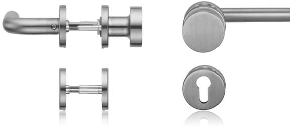
Die blaugelb Wechselgarnitur ZT/KGT FS L-Form PZ Klasse 4 ist für Feuer-, Rauch- und Fluchtwegtüren mit erhöhtem Sicherheitsanspruch in puncto Feuerschutz nach DIN 18273, für Notausgangverschlüsse nach DIN EN 179 und für den Objektbereich nach DIN EN 1906 geeignet und dementsprechend geprüft. Die mitgelieferten Schlüsselrosetten (PZ) verfügen ebenso wie die Drückerrosetten über Stütznocken zur exakten und dauerhaften Positionierung an der Tür.
