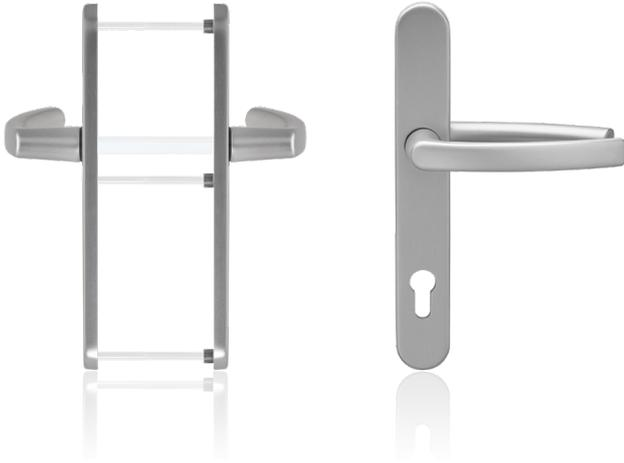
Die blaugelb Drückergarnitur DGT35 PZ92 mit einer Schildbreite von 35 mm (Entfernung PZ92) ist für Holz-, Kunststoff- und Metallaußentüren geeignet. Sie ist mit einer Hochhaltefeder zur exakten Positionierung des Drückers ausgestattet. Dabei unterstützt die Hochhaltefeder die Schlossnussfeder zusätzlich bei der Rückholung der Drückerfalle.
