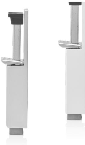
Der blaugelb Türfeststeller HUB 60 ist ein universeller Türfeststeller für glatte Böden. Ein mit Federkraft gegen den Boden drückender Tretbolzen erlaubt das Feststellen der Türe in jedem Öffnungswinkel.
