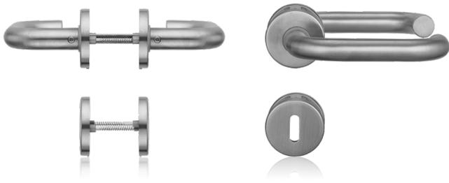
Die blaugelbe Drückergarnitur ZT/DGT U-Form Klasse 3 ist für Innentüren mit erhöhtem Anspruch nach DIN EN 1906 für den Objektbereich geeignet und dementsprechend geprüft. Die mitgelieferten Schlüsselrosetten decken die Bereiche PZ, BB und WC ab und verfügen ebenso wie die Drückerrosetten über Stütznocken zur exakten und dauerhaften Positionierung an der Tür. Durch die eingesetzten Hochhaltefedern ist eine exakte Druckerposition garantiert.
