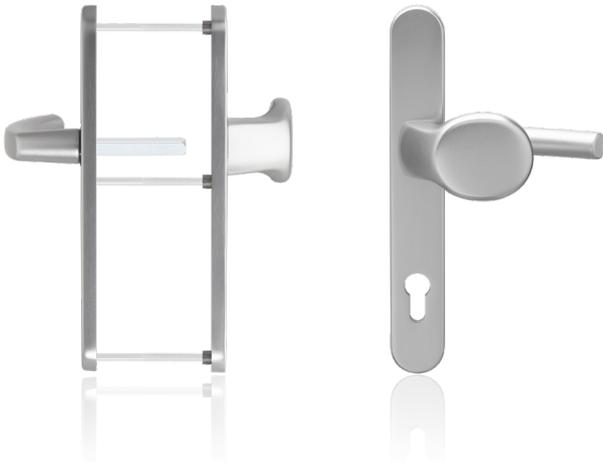
Die blaugelb Wechselgarnitur KGT35 PZ92 mit einer Schildbreite von 35 mm (Entfernung PZ92) ist für Holz-, Kunststoff- und Metallaußentüren geeignet. Sie ist mit einer Hochhaltefeder zur exakten Positionierung des Drückers ausgestattet. Dabei unterstützt die Hochhaltefeder die Schlossnussfeder zusätzlich bei der Rückholung der Drückerralle.
