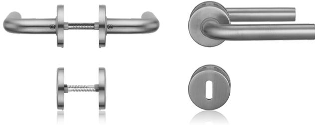
Die blaugelb Drückergarnitur ZT/DGT L-Form Klasse 3 ist für Innentüren mit erhöhtem Anspruch nach DIN EN 1906 für den Objektbereich geeignet und dementsprechend geprüft. Die mitgelieferten Schlüsselrosetten decken die Bereiche PZ, BB und WC ab und verfügen ebenso wie die Drückerrosetten über Stütznocken zur exakten und dauerhaften Positionierung an der Tür. Durch die eingesetzten Hochhaltefedern ist eine exakte Druckerposition garantiert.
