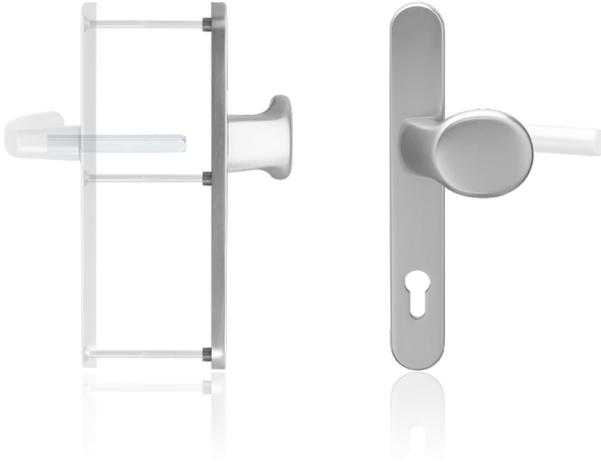
Die blaugelb Wechselgarnitur ½ KGT30 außen PZ92 mit einer Schildbreite von 30 mm (Entfernung PZ92) ist für Holz-, Kunststoff- und Metallaußentüren geeignet. Die Garnitur kann mit einer blaugelb ½ DGT30 innen PZ92 kombiniert werden.
