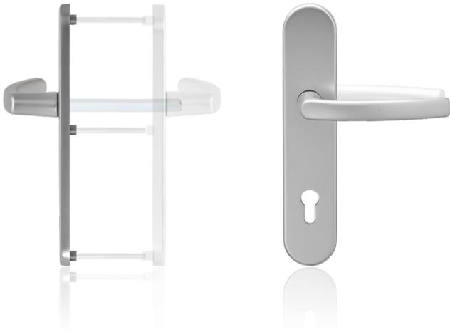
Die blaugelb Drückergarnitur ½ DGT50 innen PZ92 mit einer Schildbreite von 50 mm (Entfernung PZ92) ist für Holz-, Kunststoff- und Metallaußentüren geeignet. Sie ist mit einer Hochhaltefeder zur exakten Positionierung des Drückers ausgestattet. Dabei unterstützt die Hochhaltefeder die Schlossnussfeder zusätzlich bei der Rückholung der Drückerralle.
