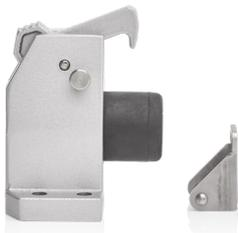
Der blaugelb Türfeststeller mit Anschlagpuffer ist ein Türfeststeller mit Fanghaken und integriertem, gefederten Anschlagpuffer. Die Montage des Feststellers erfolgt direkt im Boden, das Gegenstück wird am Türflügel montiert. Durch die integrierte Feder ist der blaugelb Türfeststeller speziell für mittelschwere bis schwere Türen mit einer Türbreite bis 1000 mm, einer Türhöhe bis 2200 mm und einem Gewicht bis 100 kg geeignet.
