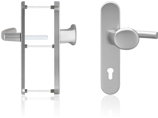
Die blaugelb Wechselgarnitur KGT50 PZ92 mit einer Schildbreite von 50 mm (Entfernung PZ92) ist für Holz-, Kunststoff- und Metallaußentüren geeignet. Sie ist mit einer Hochhaltefeder zur exakten Positionierung des Drückers ausgestattet. Dabei unterstützt die Hochhaltefeder die Schlossnussfeder zusätzlich bei der Rückholung der Drückerfalle.
