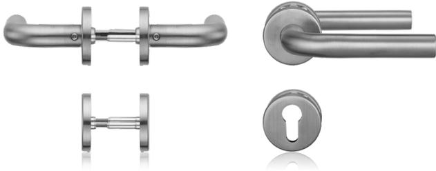
Die blaugelb Drückergarnitur ZT/DGT FS L-Form PZ Klasse 4 ist für Feuer-, Rauch- und Fluchtwegtüren mit erhöhtem Sicherheitsanspruch in puncto Feuerschutz nach DIN 18273 und für den Objektbereich nach DIN EN 1906 geeignet und dementsprechend geprüft. Die mitgelieferten Schlüsselrosetten (PZ) verfügen ebenso wie die Drückerrosetten über Stütznocken zur exakten und dauerhaften Positionierung an der Tür.
