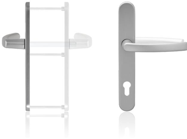
Die blaugelb Drückergarnitur ½ DGT30 innen PZ92 mit einer Schildbreite von 30 mm (Entfernung PZ92) ist für Holz-, Kunststoff- und Metallaußentüren geeignet. Sie ist mit einer Hochhaltefeder zur exakten Positionierung des Drückers ausgestattet. Dabei unterstützt die Hochhaltefeder die Schlossnussfeder zusätzlich bei der Rückholung der Drückerralle.
