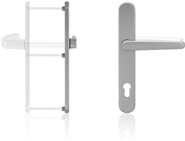
Die blaugelb Rolladengarnitur ½ NGT35 außen PZ92 mit einer Schildbreite von 35 mm (Entfernung PZ92) ist für Holz-, Kunststoff- und Metallaußentüren geeignet. Der niedrige (flache) Drücker ist speziell für Außentüren mit Rollläden, Sonnenschutz, Jalousien und Insektenschutz konzipiert. Die blaugelb Rolladengarnitur ½ NGT35 außen PZ92 kann mit einer blaugelb ½ DGT35 innen PZ92 kombiniert werden.
