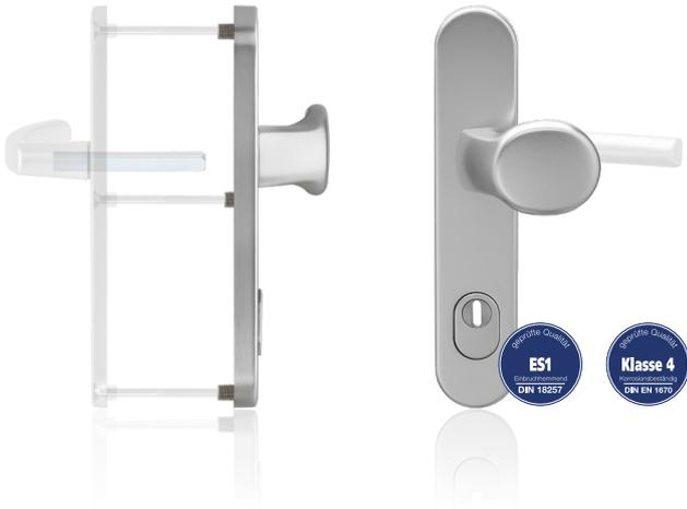
Die blaugelb Wechselgarnitur ½ KGT50 außen PZ92 ZA ES1 mit einer Schildbreite von 50 mm (Entfernung PZ92) und einem ES1 geprüften Kernziehschutz ist für Holz-, Kunststoff- und Metallaußentüren geeignet. Damit die Wechselgarnitur etwaigen Anbohrversuchen standhalten kann, wurde die Unterkonstruktion aus gehärtetem Stahl gefertigt. Die Wechselgarnitur kann mit einer blaugelb ½ DGT50 innen PZ92 kombiniert werden.
