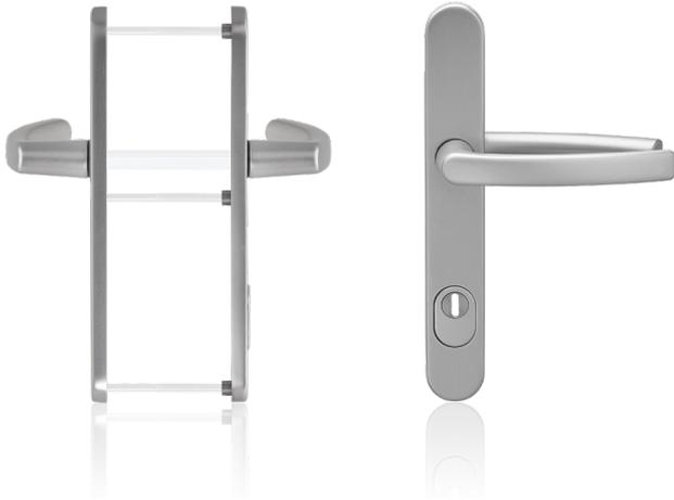
Die blaugelb Drückergarnitur DGT35 PZ92 ZA mit einer Schildbreite von 35 mm (Entfernung PZ92) und einem Kernziehschutz ist für Holz-, Kunststoff- und Metallaußentüren geeignet. Sie ist mit einer Hochhaltefeder zur exakten Positionierung des Drückers ausgestattet. Dabei unterstützt die Hochhaltefeder die Schlossnussfeder zusätzlich bei der Rückholung der Drückerfalle.
