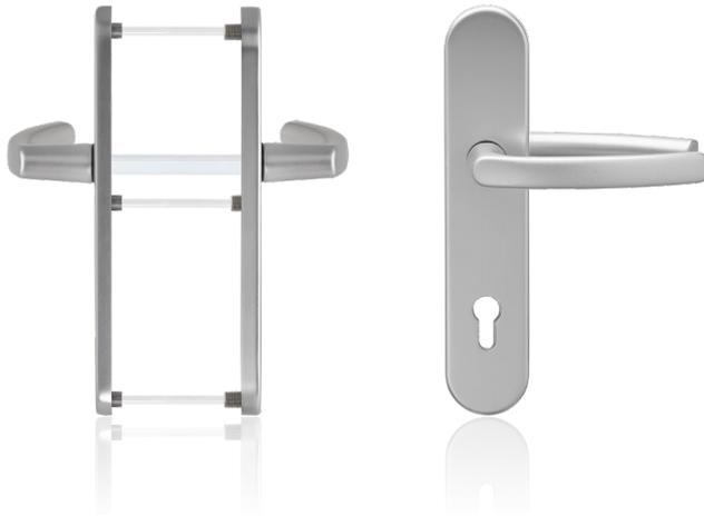
Die blaugelb Drückergarnitur DGT50 PZ92 mit einer Schildbreite von 50 mm (Entfernung PZ92) ist für Holz-, Kunststoff- und Metallaußentüren geeignet. Sie ist mit einer Hochhaltefeder zur exakten Positionierung des Drückers ausgestattet. Dabei unterstützt die Hochhaltefeder die Schlossnussfeder zusätzlich bei der Rückholung der Drückerfalle.
