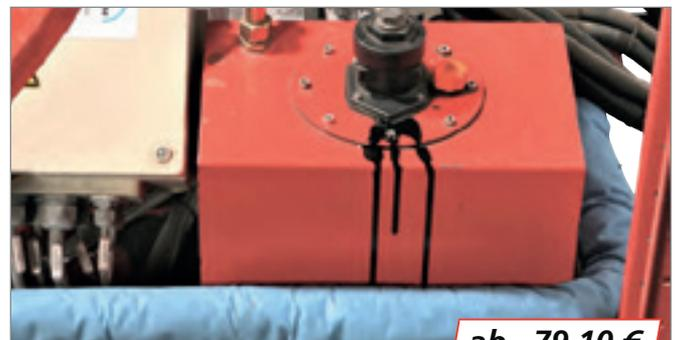
Saugschlauch verhindert die Ausbreitung von Öl um Maschinen
