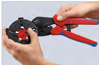
Crimpeinsatz-Wechsel: Magazinposition entsperren, Crimpeinsatz mit der Zange entnehmen.
