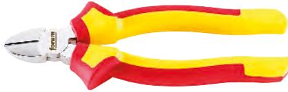
**Kopf verchromt**, Griffe mit Mehrkomponenten-Kunststoffhüllen, isoliert bis 1000 V, nach IEC 60900, EN 60900 und VDE 0682 Teil 201, Vanadium-Elektrostahl, schlanke Kopfform, sauberer Schnitt bei dünnen Kupferdrähten
