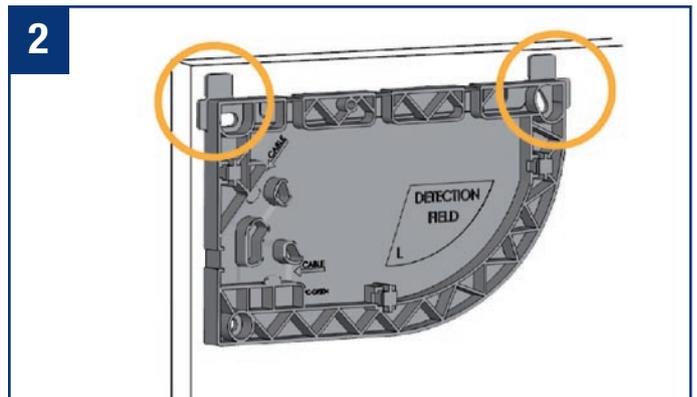
Befestigen Sie die Montageplatte auf dem Türrahmen. Die Abstandshalter ermöglichen Ihnen die Montageplatte richtig auszurichten.
