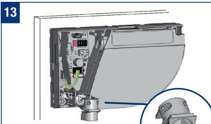
Verschließen Sie den Sensor, der nicht mit der Türsteuerung verbunden wird.
