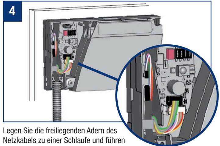
Legen Sie die freiliegenden Adern des Netzkabels zu einer Schlaufe und führen Sie sie durch die Aussparung. Klemmen Sie die Adern mit dem überschüssigen Kabel fest.
