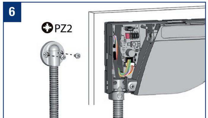
Befestigen Sie das andere Kabelübergangsende mit dem Endstück.
