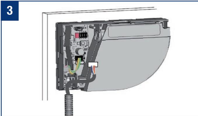
Führen Sie das Netzkabel durch den Kabelübergang. Stecken Sie den Stecker in die weiße Anschlussbuchse.
