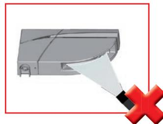
Direktes Bestrahlen mit Hochdruckreiniger ist zu vermeiden.
