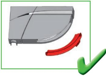
Vor dem Einlernen oder der Inbetriebnahme des Sensors, den Laserfensterschutz entfernen.
