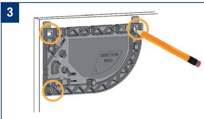
Markieren Sie mit einem Bleistift die in den Türrahmen zu bohrenden Löcher. Der Innenbereich der Montageplatte kann auch zur Befestigung der Schrauben genutzt werden.
