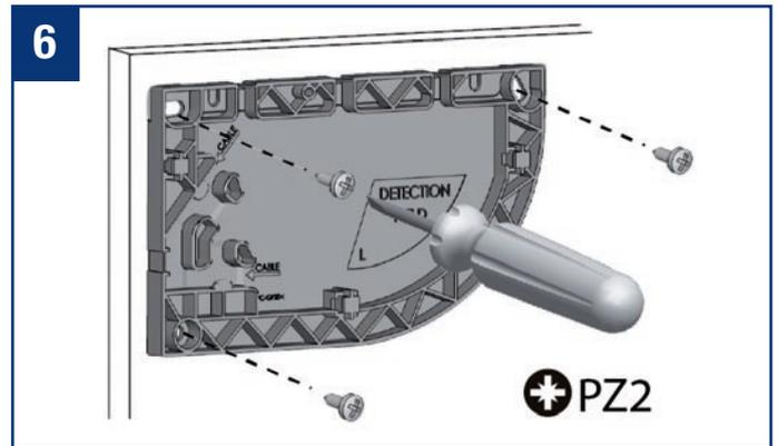
Befestigen Sie die 3 Schrauben mit einem PZ2-Schraubendreher. Die Montageplatte muss fest angeschraubt werden!
