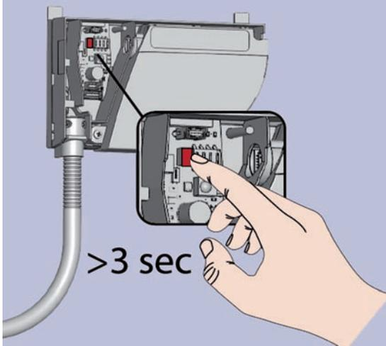
Der Service-Modus deaktiviert die Absicherungserfassung des Sensors während 15 Minuten und kann während der Installation, dem mechanischen Einlernen des Antriebes oder bei Wartungsarbeiten nützlich sein.
