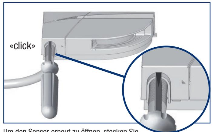
Um den Sensor erneut zu öffnen, stecken Sie einen Schraubendreher in die Aussparung unten am Sensor und ziehen Sie diesen nach oben.
