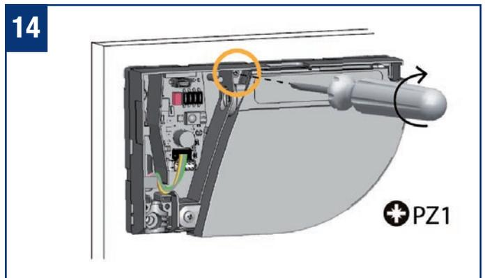
Ziehen Sie die Fixierschraube an, um den Sensor fest mit der Montageplatte zu verbinden.
