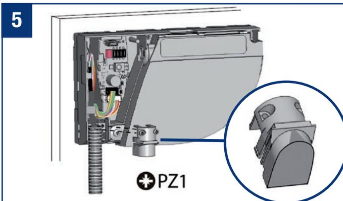
Befestigen Sie den Kabelübergang mit der Zugentlastung am Sensor. Ziehen Sie die 2 Schrauben fest, um zu verhindern, dass das Kabel herausgezogen werden kann.
