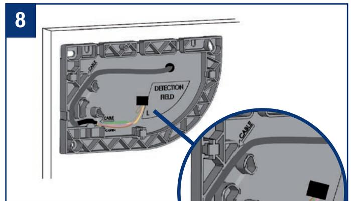
Führen Sie das Master-Slave-Kabel durch die Bohrung. Legen Sie das Kabel in die Aussparung auf der Montageplatte und stellen Sie sicher, dass es fest sitzt.
