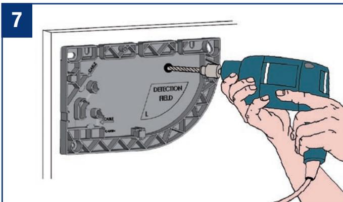
Bohren Sie mit einem 10-mm-Bohrer durch die Montageplatten und die Tür, um das Master-Slave-Kabel durchführen zu können. Entgraten Sie die Bohrung mit Schleifpapier.
