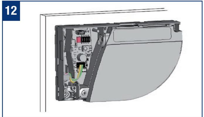
Führen Sie die Adern durch die Aussparung, damit Sie diese nicht beim Aufsetzen der Abdeckung eindrücken.
