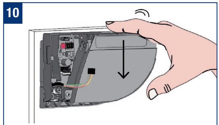
Führen Sie das Kabel durch das Loch auf der Sensorrückseite und befestigen Sie den Sensor auf die Montageplatte, indem Sie ihn nach unten schieben.
