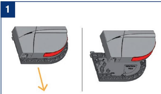
Ziehen Sie die hinter dem Melder befestigte Montageplatte ab.
