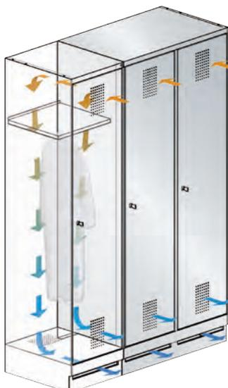
**Belüftungskonzept** – Durch den optimierten Strömungsverlauf funktioniert die Belüftung ohne zusätzliche Lüftungseinrichtungen. Selbst bei Schränken mit Sockel ist eine gleichmäßige Belüftung des gesamten Innenraumes sichergestellt!
