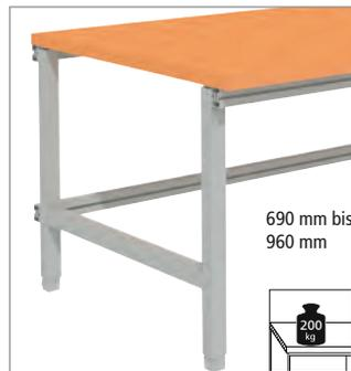
Tischgestell manuell höhenverstellbar über Verschraubung im Höhenraster von 20 mm. Nivellierfüße mit 20-mm-Einstellbereich.
