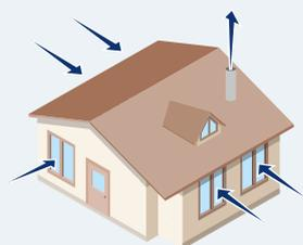
Die Schachtlüftung wird auch als Schwerkraftlüftung bezeichnet. Ihr Antrieb ist die Thermik, die in einem Schacht entsteht. Dieser Schacht führt die Abluft nach außen und baut einen Unterdruck in der Wohnung auf. Dadurch kann über arimeo Frischluft in die einzelnen Räume nachströmen. Die Schachtlüftung ist auch für einseitig ausgerichtete Wohnungen geeignet. Oft sind die Anschlüsse für Schächte beispielsweise in innen liegenden Bädern integriert.
