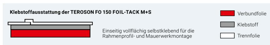
Die Teroson FO 150 FOIL-TACK M+S ist die neue Generation der Fassadenfolie. Sie zeigt deutliche Verbesserungen in Sachen Robustheit und Klebkraft. Die fortschrittliche Hotmelt-Ausstattung und der vollständige Verzicht auf Bitumen-Compound macht die Folie leichter und dünner – und damit flexibler und montagefreundlicher.
