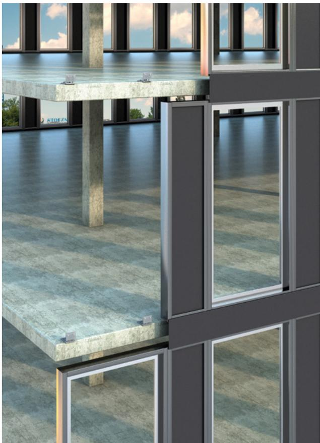
*Konstruktionsweise einer Elementfassade*
