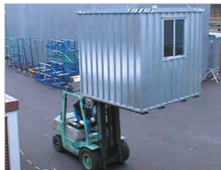
Abstandhalter: sicherer Stapler-Transport, Bodenbelüftung
