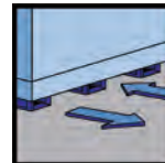
Bodenbelüftung: dauerhafter Schutz gegen Feuchtigkeit und Fäulnis
