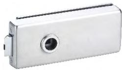
Das Glastürschloss Serie 6080 ist für 8 mm ESG Glas einsetzbar. Beim Einsatz mit 10 mm ESG Glas muss entweder eine Zarge mit 26 mm Falztiefe eingesetzt, oder spezielle Fallenstücke für 10 mm Glas verwendet werden.
