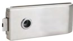
Das Glastürschloss Serie 6140 ist für 8 mm ESG Glas einsetzbar. Beim Einsatz mit 10 mm ESG Glas muss entweder eine Zarge mit 26 mm Falztiefe eingesetzt, oder spezielle Fallenstücke für 10 mm Glas verwendet werden.
