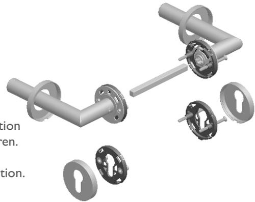
Türdrücker fest/drehbar gelagert auf einer Metall/Kunststoff - Unterkonstruktion für optimale Absorbierung axialer und radialer Kräfte bei vielbegangenen Türen. Modernes Rosettendesign unsichtbar verschraubt. Hochhaltefeder mit Drehbegrenzung für waagerechten Sitz der Drückerposition. (Feuerschutz - Ausführung ohne Hochhaltefeder) Drücker aus Edelstahl V2A Rohr.
