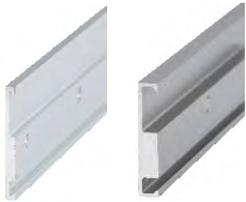
Einbau in Verbindung mit der San Remo Laufschiene 9170 zur Wandmontage oder Deckenmontage. Die Abstandsprofile können bis zu 20 mm übereinander gestapelt werden. Durch den Einsatz der Endkappen mit Abbrechkante #23011 werden die Abstandsprofile seitlich abgedeckt. Abstandsprofil bis bei 20 mm Höhe eine stabile Grundlage der Schiebetürkonstruktion. Auf entsprechende Tragfähigkeit der Wand achten!
