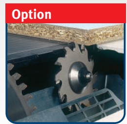
Vorritzer ▶ Vorritzeinrichtung mit Sägeblatt
