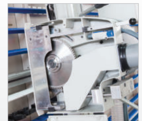
▶ Große Öffnung für Sägeblattwechsel
