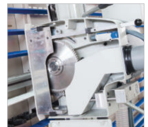
▶ Große Öffnung für Sägeblattwechsel
