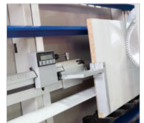
▶ Digitale Maßanzeige zur Längeneinstellung beim Vertikalschnitt
