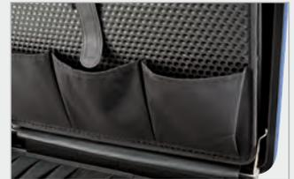
Die Werkzeugtafeln sind herausnehmbar und bestehen aus widerstandsfähigem Mehrschichtkunststoff, die kleinen Vertiefungen sorgen für zusätzliche Stabilität.
